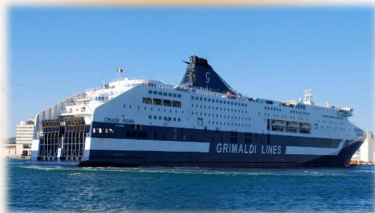
El buque tiene 213.88m de eslora por 32.25m de manga. Su diseño le permite transportar todo tipo de carga rodada, incluso dispone de cubierta al aire libre que emplea para contenedores estándar.
